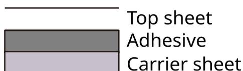
Etiketten bestehen aus drei Lagen, wie in der Abbildung gezeigt. Die Klebelage enthält Materialien, die leicht von den im Gerät angewandten Kraft beeinflusst werden. Die obere Lage haftet auf dem Trägerblatt, bis das Etikett verwendet wird. Diese Zusammensetzung von Etiketten kann zu weiteren Problemen führen.
