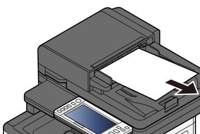
**2 Otevřete kryt podavače dokumentů a odstraňte zaseknutý papír.**
