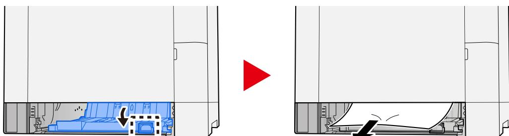
**6 Vratě kryt podavače do původní polohy a vratě zásobník 1 do původní polohy.**
