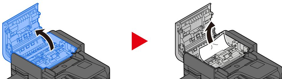
**3 Otáčením ovladače C odstraňte zaseknutý papír.**
