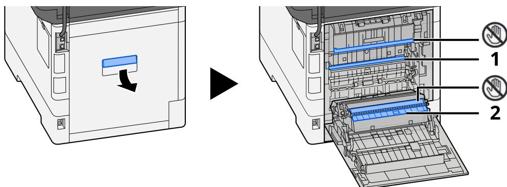
Otřete papírový prach z papíru 1 a nečistoty z papíru 2 pomocí měkkého, suchého hadříku.
