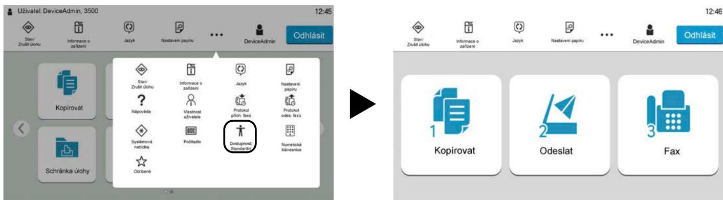
Obrazovku můžete ovládat také pomocí číselného tlačítka odpovídajícího číslu. (Příklad: Stisknutím tlačítka [2] na číselné klávesnici zobrazíte obrazovku Odeslat.)
