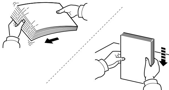
Stožek papíru prolistujte, pak s ním zaklepejte o rovný povrch. Dále je třeba dbát na následující.
