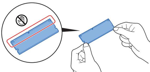
Для защиты электронных деталей необходимо перед началом работы с модулями памяти снять с тела статический заряд, коснувшись водопроводной трубы (крана) или другого крупного металлического предмета. Во время установки модулей памяти следует по возможности носить антистатический браслет.
